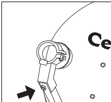
▶ Em seguida, fixe o suporte plástico do LNBF. Encaixe a peça na ponta do suporte utilizando o parafuso e a porca. Aperte com a chave de dez milímetros.
