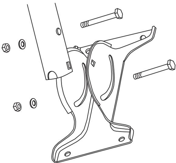
▶ Monte a base encaixando o cano na base e coloque os parafusos.
