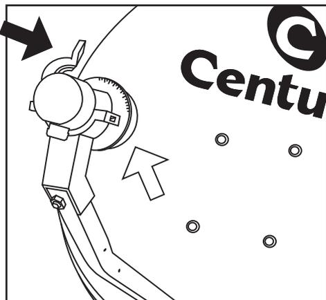
▶ Fixe o LNBF\* na antena. Abra o suporte posicione a peça com o lado indicado voltado para a antena.
