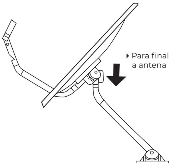
▶ Para finalizar, encaixe a antena na base.
