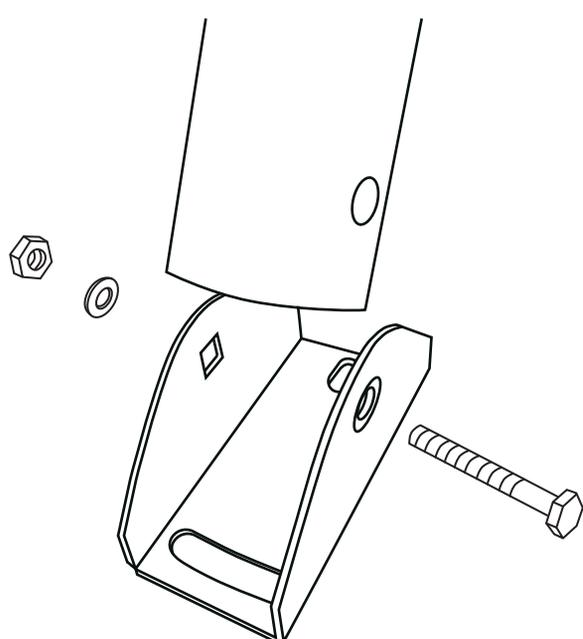
► Usando as chaves, monte a peça encaixando o cano na base e coloque o parafuso.
