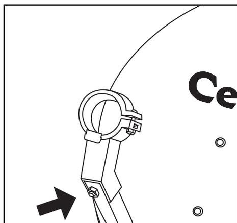
► Em seguida, fixe o suporte plástico do LNBF. Encaixe a peça na ponta do suporte utilizando o parafuso e a porca e aperte.
