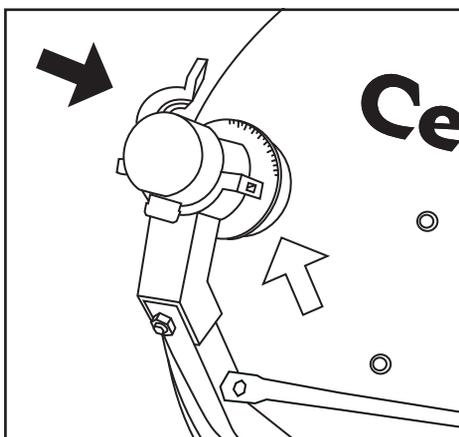
► Fixe o LNBF\* na antena. Abra o suporte e posicione a peça com o lado indicado voltado para a antena.
